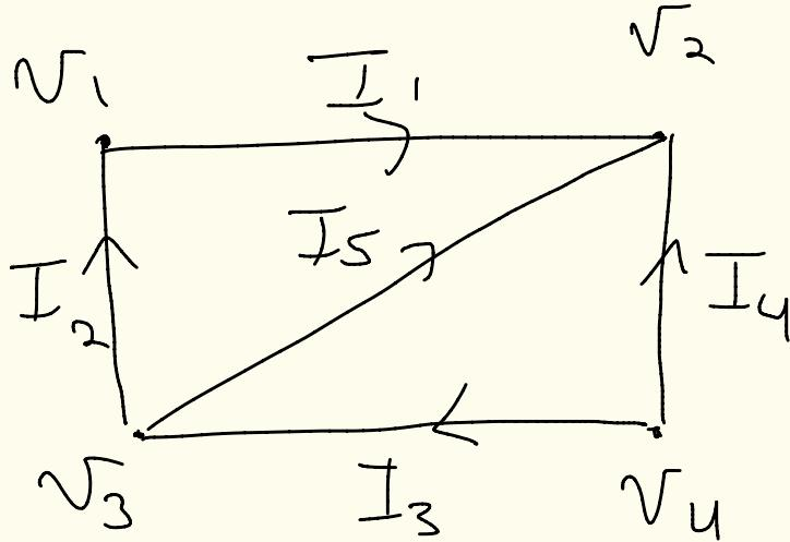
$$A = \begin{bmatrix} I_1 & V_1 & V_2 & V_3 & V_4 \\ I_2 & -1 & 1 & 0 & 0 \\ I_3 & 1 & 0 & -1 & 0 \\ I_4 & 0 & 0 & 1 & -1 \\ I_5 & 0 & 1 & 0 & -1 \end{bmatrix}$$
